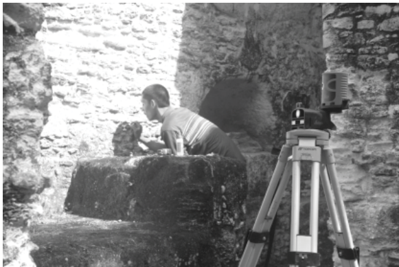
Fig. 2. Colocación de dianas para crear fotoplanos.
