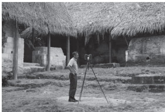
Fig. 6. Toma de datos con el escáner láser Faro Focus 3D S120. (Foto C. Vidal).
